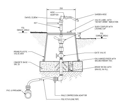
TYPICAL QUICK COUPLER VALVE DETAIL
