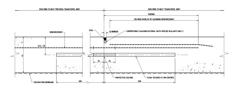
**EMERGENCY TRANSVERSE CONSTRUCTION JOINT** (JOINTED REINFORCED CONCRETE SLABS ONLY)
